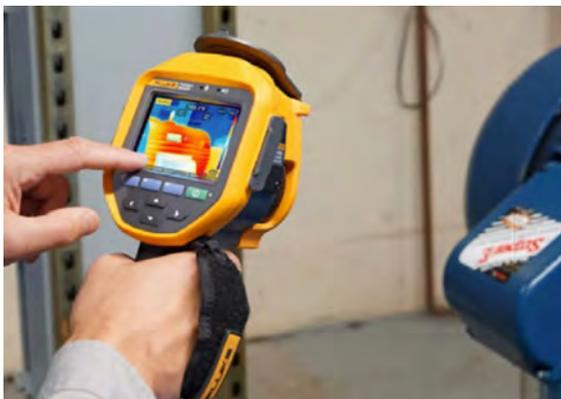
Fluke Ti480 Pro utilizado para inspecciones de motores
