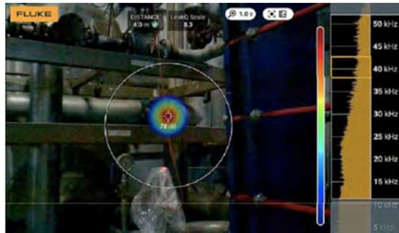
Fuga de vapor capturada con la Fluke ii910 en una planta de elaboración de alimentos y bebidas
