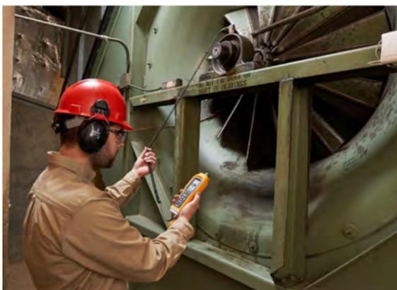
Imagen 6: Fluke 805FC con sensor externo
