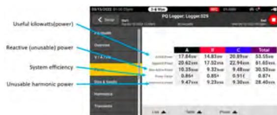
Imagen 4: Potencia útil e inutilizable capturada por el Fluke 1777
