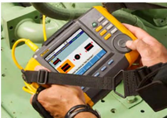
Imagen 5: Medidor de vibraciones Fluke 805FC
